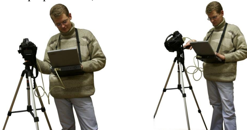
Съёмка производится Ик – камерой закреплённой на штативе.
