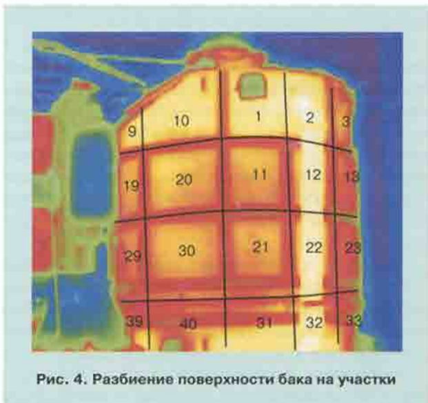
Рис. 3. Термограмма части поверхности бака реактора
